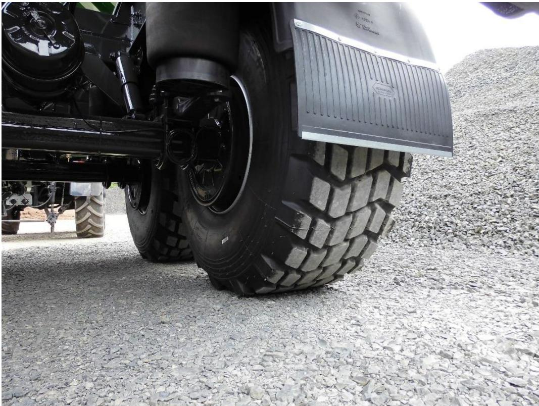
Für den Rahmen verwenden wir ausschließlich einen hochfestem Feinkornstahl und verbauen eine spezielle Achsgeometrie um diese Reifen Felgenkombination möglich zu machen. Das Fahrzeug ist ein idealer Partner für Ihren LKW und den Schlepper.
