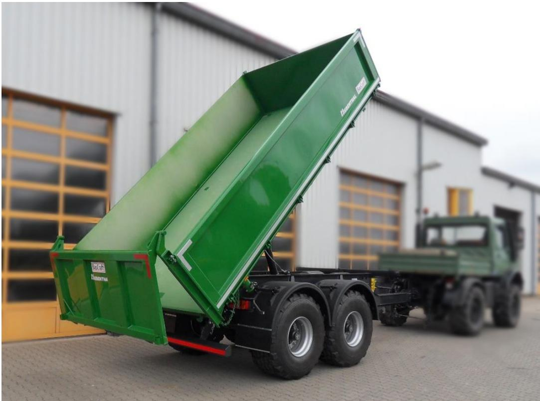
Um den Kippwinkel der Heckklappe zu vergrößern haben wir das Kipplager nach oben und vorne versetzt. Dadurch wird die Klappe weiter geöffnet und die Entladung beschleunigt.
