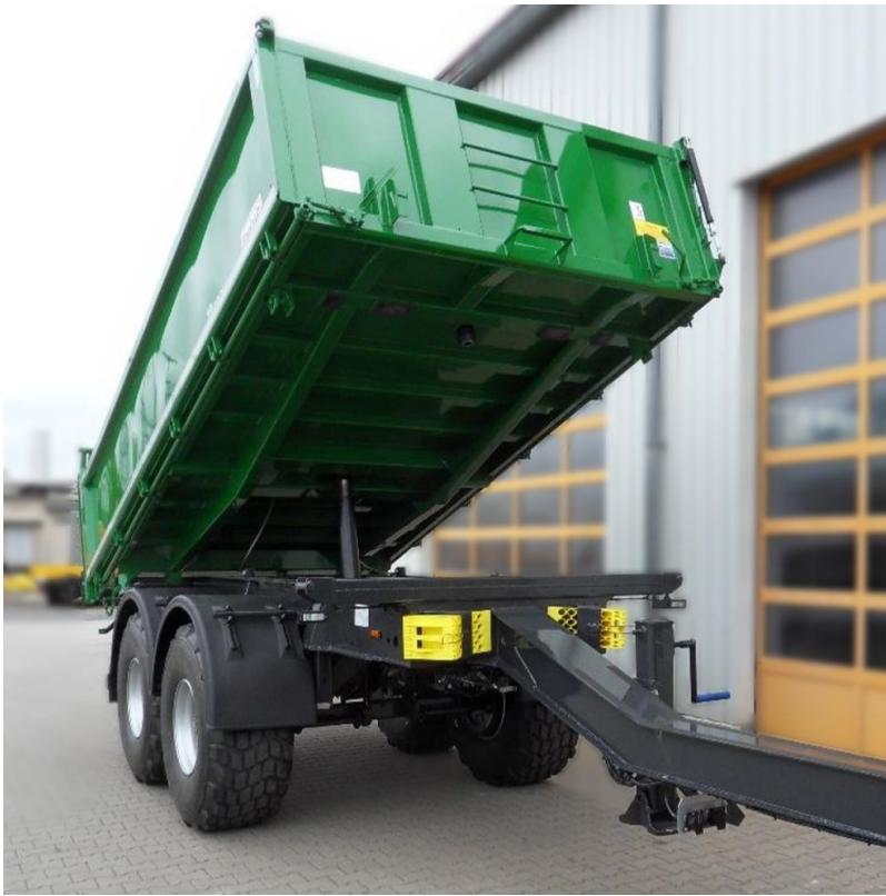
Die Zugeinrichtung wurde gegenüber dem TKB 18 um 300 mm verlängert. Die Wendigkeit des Fahrzeuges wurde dadurch erhöht, da der Winkel zwischen Zugfahrzeug und Hänger ca. 180 Grad betragen kann. Das gekröpfte Zugrohr ist mit einer 50er Zugöse ausgerüstet. Die Höhenanpassung an Ihr Zugfahrzeug wird durch umschrauben der Zugöse
